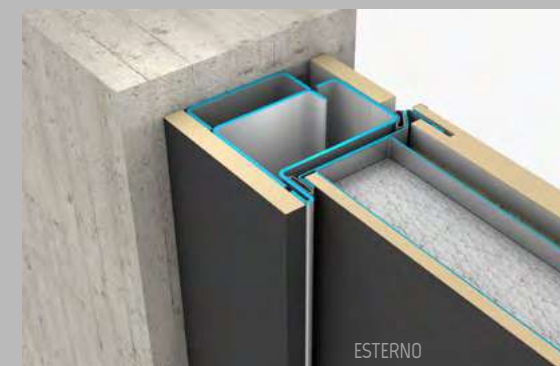
9 Soluzione posa telaio centro muratura con profili di copertura telaio interni ed esterni (posa controtelaio con profilo di compensazione saldato sul telaio)
